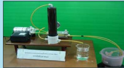
รูปที่ 4. ทดสอบการกรองสารละลายแม่เหล็ก (แมกนีไทด์สังเคราะห์) ที่แขวนลอยอยู่ในน้ำ โดยใช้อลูมินาพอร์น (a) สารละลายก่อนกรอง (b) สารละลายหลังกรอง
