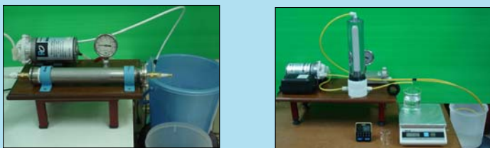
รูปที่ 2 ชุดทดสอบ เซรามิกพอร์น แบบ cross-flow ในแนวนอน (a) แนวตั้ง (b)
