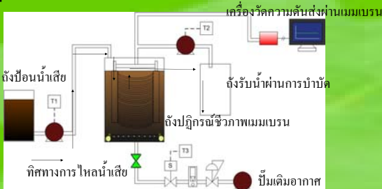
ภาพประกอบที่ 1 แบบจำลองถังปฏิกรณ์ชีวภาพเมมเบรนในระดับห้องปฏิบัติการ
